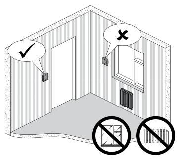
Для корректной работы в помещении пульт управления необходимо установить в месте, которое имеет максимально стабильные температурные показатели для данного помещения и не подвержено температурному воздействию от радиаторов системы отопления, конвективного вертикального распределения температуры и т. д.
