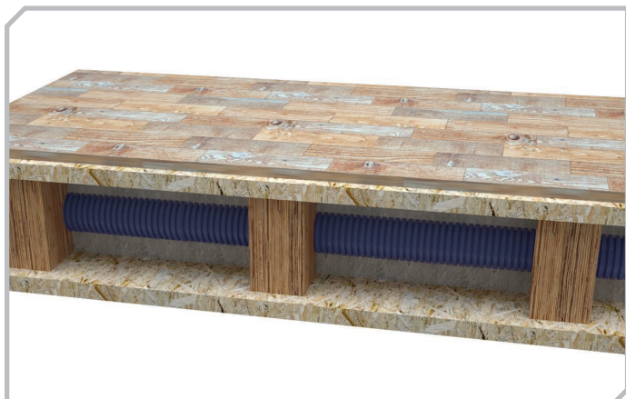
Внутри деревянных перекрытий через балки
