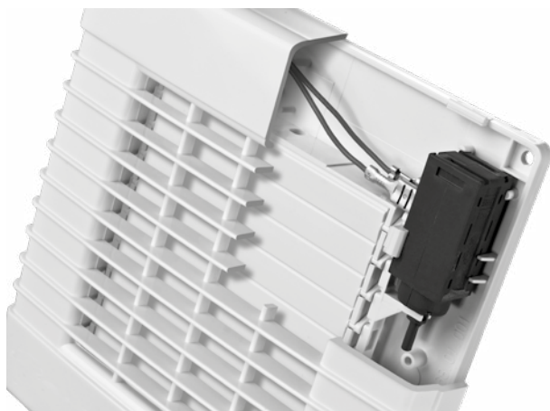
Проветриватель не работает — жалюзи закрыты
