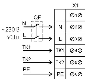
Схема подключения вентиляторов ВКП 4Д 600\*350; ВКПФ(И) 4Д 400\*200; ВКПФ(И) 4Д 500\*250; ВКПФ(И) 4Д 500\*300; ВКПФ(И) 6Д 600\*320; ВКПФ(И) 6Д 500\*300; ВКПФ(И) 4Д 600\*300; ВКПФ(И) 6Д 600\*300; ВКПФ(И) 4Д 600\*350; ВКПФ(И) 6Д 600\*350; ВКПФ(И) 4Д 700\*400; ВКПФ(И) 6Д 700\*400; ВКПФ(И) 4Д 800\*500; ВКПФ(И) 6Д 800\*500; ВКПФ(И) 8Д 800\*500; ВКПФ(И) 6Д 900\*500; ВКПФ(И) 8Д 900\*500; ВКП 4Д 1000\*500; ВКП 6Д 1000\*500; ВКПФ(И) 6Д 1000\*500; ВКПФ(И) 8Д 1000\*500
