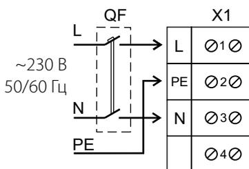
Схема подключения ВКП/ВКПИ 4Д 500\*300 (первый вариант) с трехфазным двигателем, без термоконтактов
