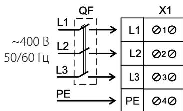
Схема подключения ВКП/ВКПИ 4Д 500\*300 (второй вариант), ВКП/ВКПИ 4Д 600\*300; ВКП 4Д 700\*400; ВКП 4Д 800\*500 с трехфазным двигателем
