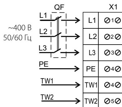
Схема подключения вентиляторов ВКПФ(И) 4Е 400\*200; ВКПФ(И) 4Е 500\*250; ВКПФ(И) 4Е 500\*250; ВКПФ(И) 6Е 500\*300; ВКПФ(И) 6Е 500\*300; ВКПФ(И) 4Е 600\*300; ВКПФ(И) 6Е 600\*300; ВКПФ(И) 4Е 600\*350; ВКПФ(И) 6Е 600\*350 с однофазным двигателем
