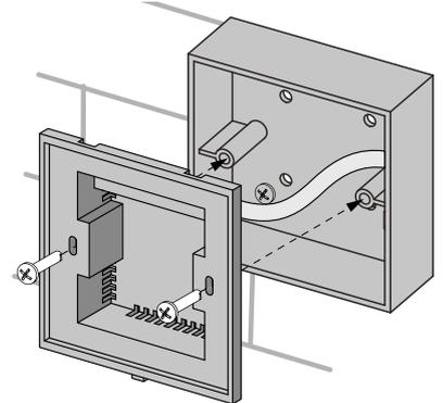
7. Закрепите экран на корпусе, прижав его до фиксации с помощью защелок.
