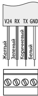
4. Подключите провода кабеля к разъему в соответствии с наклейкой на корпусе панели.
