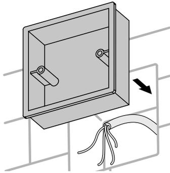
2. Проложите кабель к месту крепления панели и установите монтажную коробку для настенного монтажа с помощью винтов (не входят в комплект поставки).
