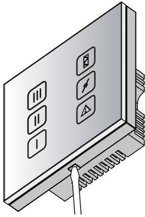
3. Аккуратно отверткой отстегните защелку на нижнем торце панели и отсоедините экран от корпуса.
