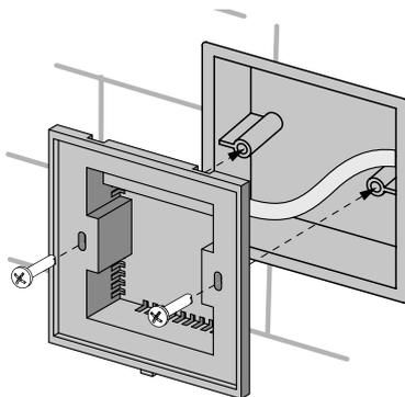
6. Закрепите тыльную часть корпуса панели на монтажной коробке через крепежные отверстия с помощью крепежных винтов. Винты для крепления панели к монтажной коробке входят в комплект панели управления.
