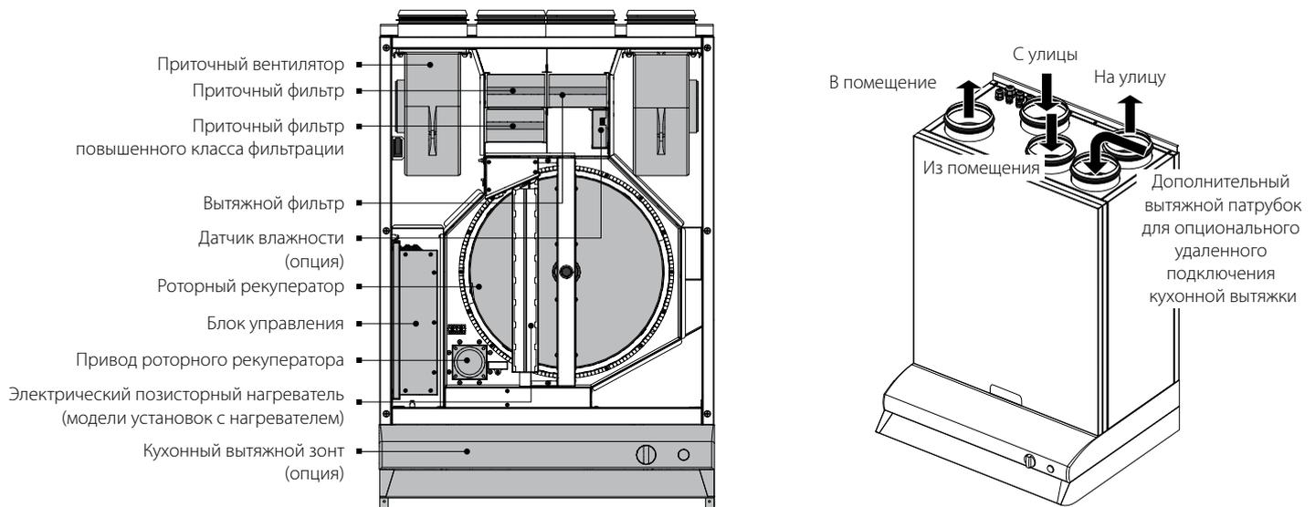
Установка представляет собой каркас, изготовленный из жестко закрепленных между собой панелей. Панели представляют собой конструкцию из листа алюминия и оцинкованного листа с расположенным между ними тепло- и звукоизоляционным слоем минеральной ваты.
