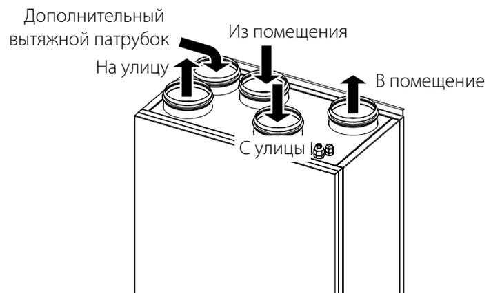
2. Снимите декоративную панель, и затем, открыв 6 винтов, снимите сервисную панель. Отсоедините от сервисной панели провод заземления. Затем снимите заднюю панель установки, открутив 6 винтов. От задней панели также необходимо отсоединить провод заземления. На место сервисной панели установите заднюю панель, а на место задней панели установите сервисную и декоративную панели.
