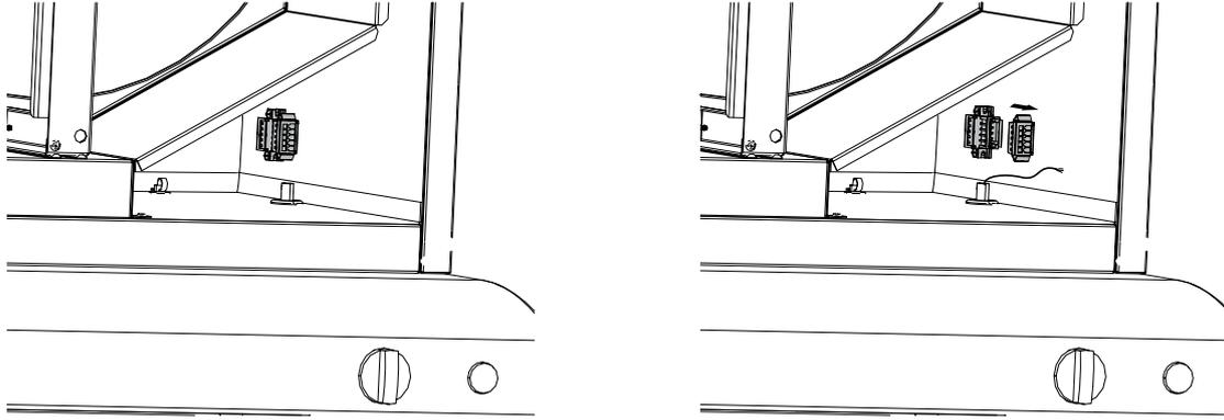
Разъем для подключения кухонного зонта (X4) находится на боковой стенке установки.
