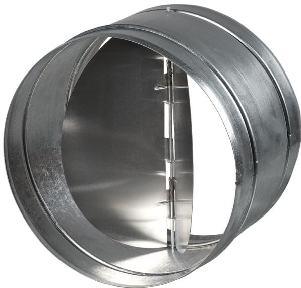
Обратный клапан с подпружиненными пластинами для перекрытия воздушного потока в круглых воздуховодах и предотвращения движения воздуха в обратном направлении при выключеной системе вентиляции
