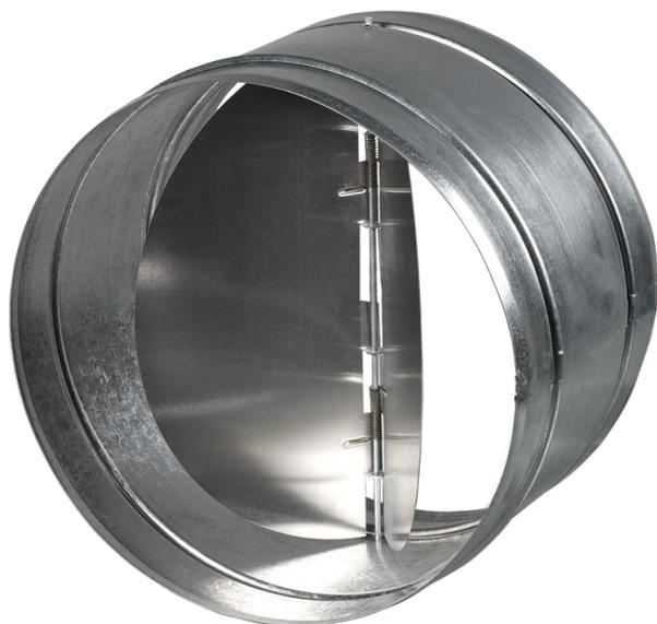
Обратный клапан с подпружиненными пластинами для перекрытия воздушного потока в круглых воздуховодах и предотвращения движения воздуха в обратном направлении при выключенной системе вентиляции
