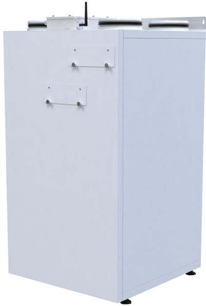
Приточно-вытяжные установки в звуко- и теплоизолированном корпусе оборудованные противоточным рекуператором, выполненным из полистирола
