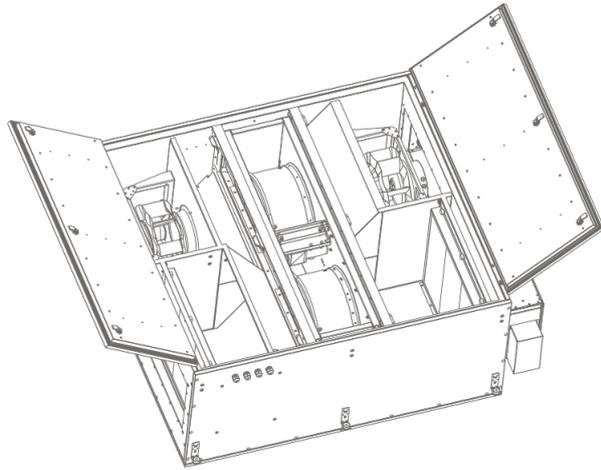
Вентиляционная приточно-вытяжная установка с рекуперацией тепла
