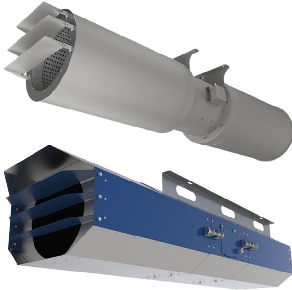
Осевые струйные вентиляторы для вентиляции крытых паркингов. Температуры перемещаемой среды: в постоянном режиме работы - до +55 °С; в режиме дымоудаления: 300-400 °С - 2 ч. Функциональность. Мощность. Экономичность
