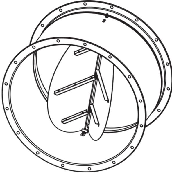
Обратный клапан с подпружиненными пластинами предназначен для перекрытия воздушного потока в круглых воздуховодах и предотвращения движения воздуха в обратном направлении при выключенной системе вентиляции
