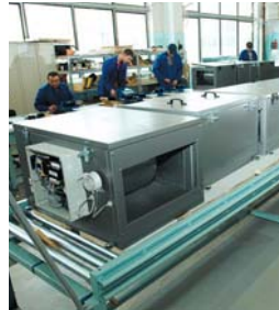
Цех изготовления приточно-вытяжных установок
