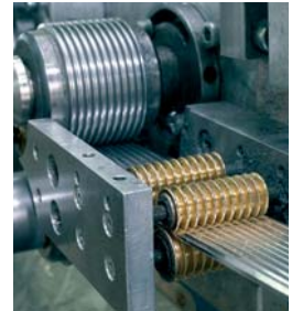
Цех изготовления гибких воздуховодов
