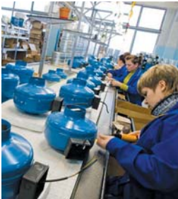
Цех изготовления коммерческой вентиляции
