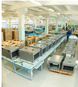
Цех изготовления промышленной вентиляции
