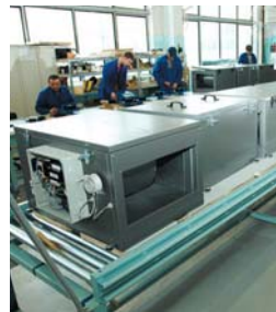
Цех изготовления приточно-вытяжных установок
