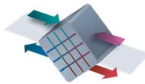
Принцип работы пластинчатого рекуператора перекрестного тока
