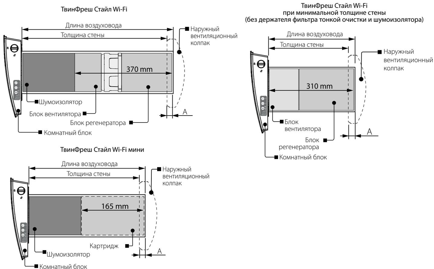
Если толщина стены меньше, чем получается по схеме расположения блоков внутри стены, то можно отстегнуть держатель фильтра тонкой очистки и собрать проветриватель без него и без шумоизоляционного материала, как показано на рисунке выше. При таком варианте монтажа может снизиться эффективность рекуперации и увеличиться проникновение уличного шума в помещение. При этом также увеличится шумность работы самого проветривателя.
