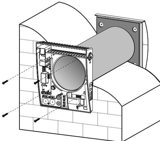
8. Заведите кабель питания, как показано на рисунке, и подключите проветриватель согласно схеме внешних подключений в разделе «Подключение к электросети». Закрепите кабель питания прижимной планкой.
