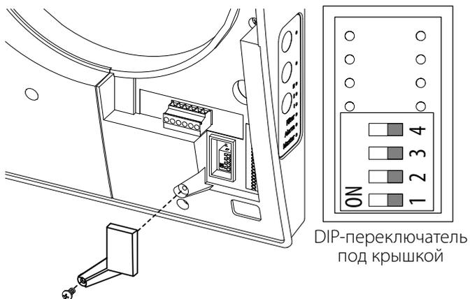
Перед началом эксплуатации проветривателя проведите его настройку с помощью DIP-переключателя, расположенного на плате контроллера.
