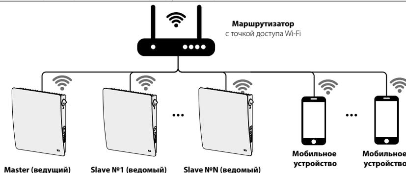
Если технические характеристики маршрутизатора не позволяют подключить необходимое количество проветривателей, можно использовать дополнительную точку доступа Wi-Fi для подключения остальных проветривателей. Также можно подключить в сеть маршрутизатора несколько ведущих устройств (Master) для организации зонального управления.
