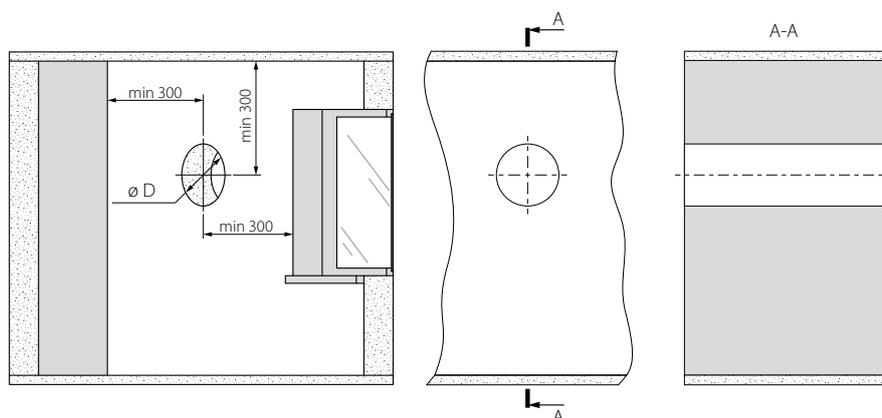
2. Установите воздуховод в стене. Для удобства монтажа используйте монтажные клинья, которые входят в комплект поставки. Снаружной стороны стены воздуховод должен выступать на расстояние А, необходимое для установки наружного вентиляционного колпака. Габаритные размеры наружного вентиляционного колпака, величина необходимого выступа воздуховода за пределы стены А и порядок монтажа колпака приведены в руководстве пользователя на колпак.
