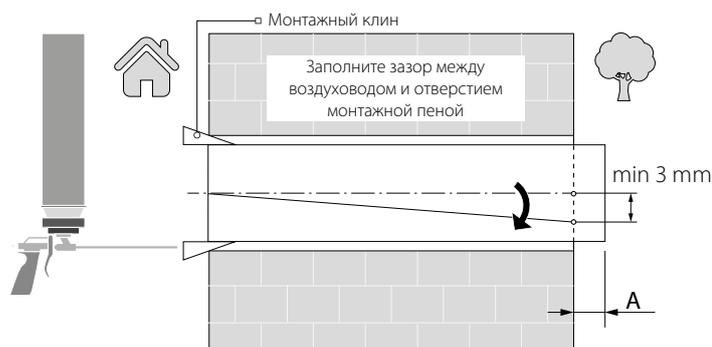
При монтаже воздушного канала обеспечьте наклон со стороны улицы минимум на 3 мм вниз.
