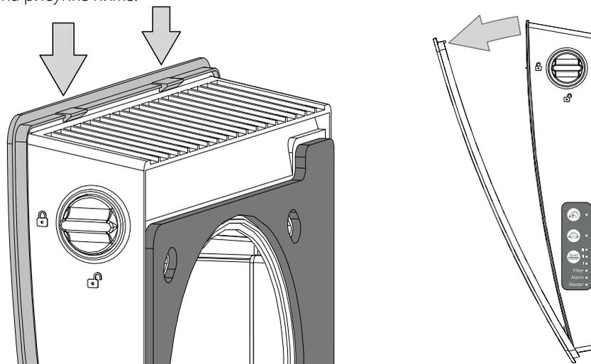
6. Открутите три самореза, удерживающих левую крышку, для доступа к клеммам подключения. Проведите провода питания сквозь соответствующие гермовводы.
