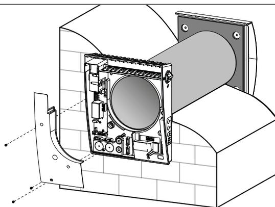
10. Установите картридж или блок регенератора и блок вентилятора в воздуховод, как показано на рисунке ниже, и подключите разъем к плате.
