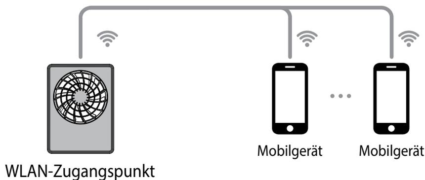
**Beispiel 2:** Anschlussschema mit einem Router mit einem einzelnen WLAN-Zugangspunkt. Ein Ventilator, Mobilgeräte und ein BMS-System „Smart Home“ stellen eine Verbindung zum WLAN-Zugangspunkt des Netzwerk-Routers her.
