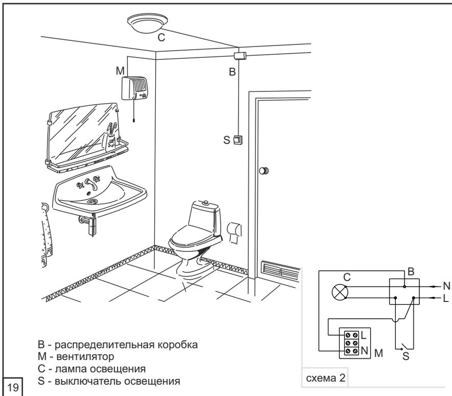
Схема подключения вентилятора без встроенного выключателя, через внешний выключатель.
