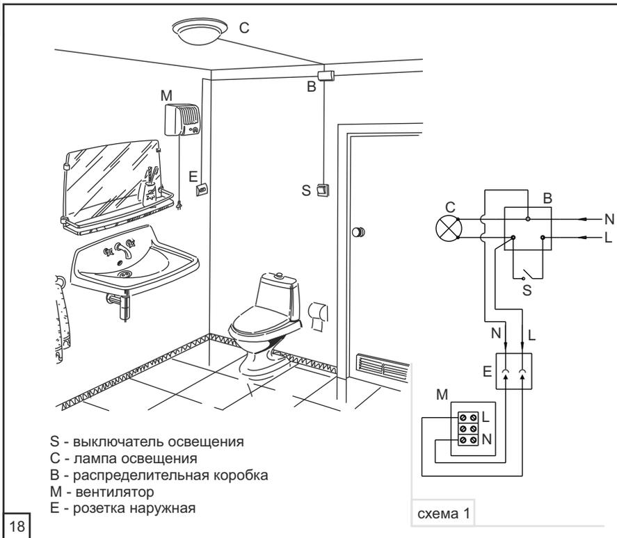
Схема подключения вентилятора, оборудованного встроенным выключателем.
