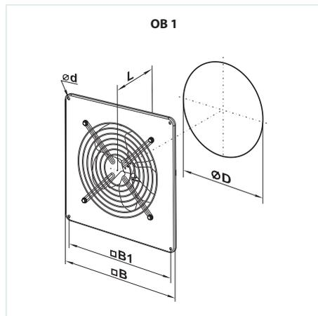
Габаритные размеры вентиляторов
