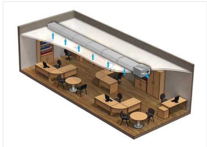
VKPFI fan office ventilation example
